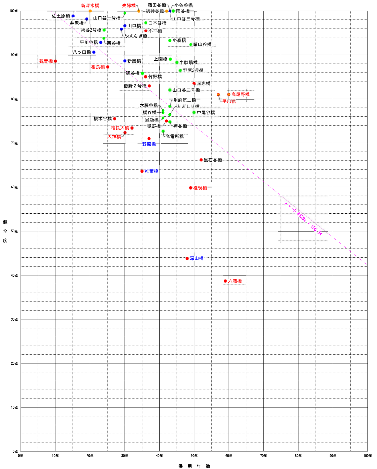
供用年数と健全度の関係 (全体 : 51橋)
