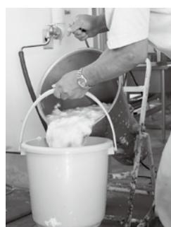
流水でアクを抜き、絞って水気を取った材料を細かく碎く。昔は棒で叩いて行っていたが、現在はミキサーを用いる。
