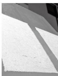
すいた和紙を重ね、重石を乗せて水を抜く。水気が抜けた和紙を板に貼り付け、天日で乾燥させる。
