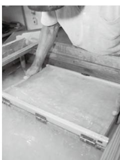
漉き舟に材料を入れ、ノリウツギの内皮やトロロアオイの根から採れる糊と混ぜ合わせる。簀柵で材料をすくい、繊維が均等に絡まるよう縦横にゆする。
