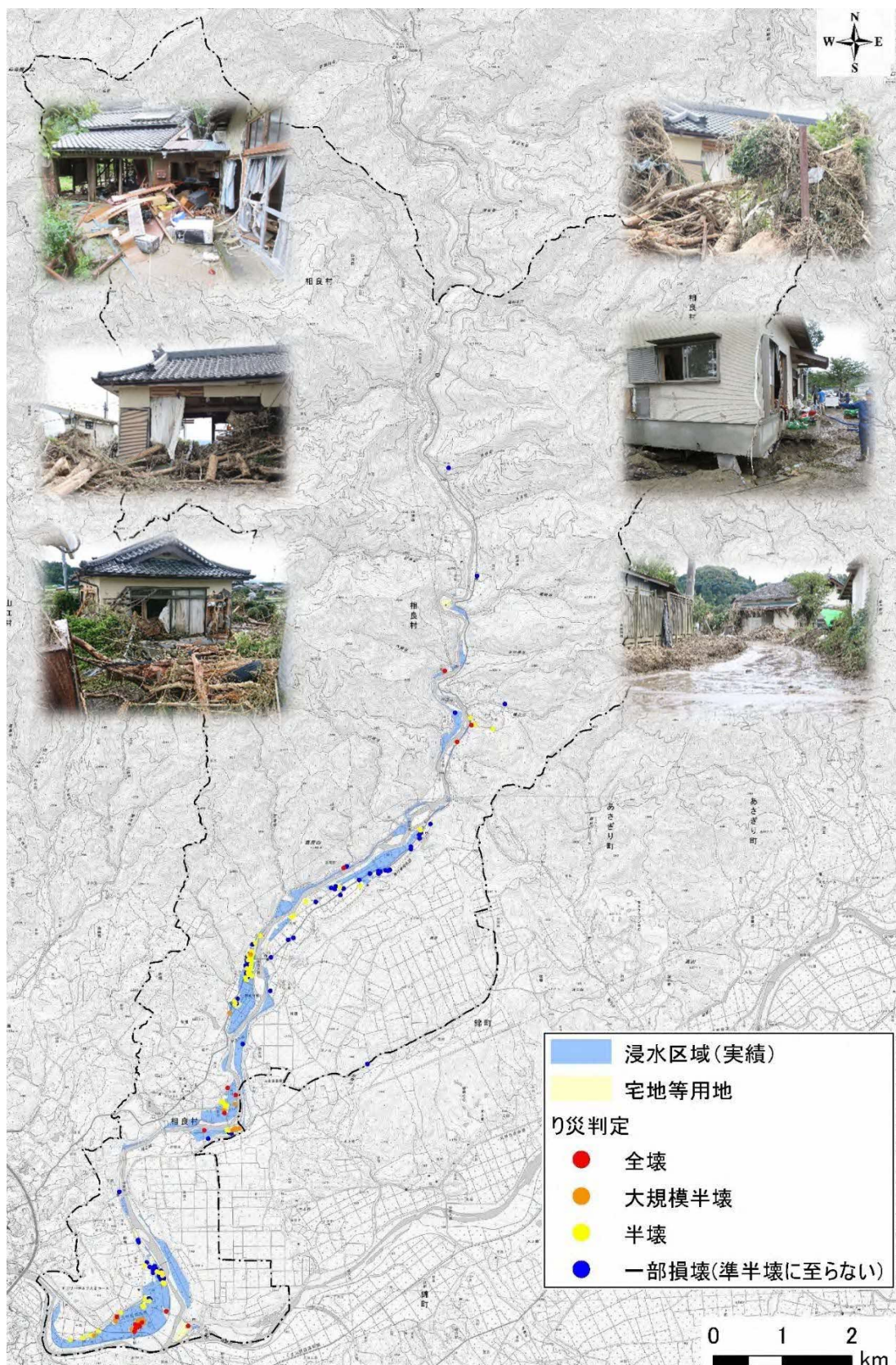
〔図〕建物被害状況及び浸水区域（実績）
