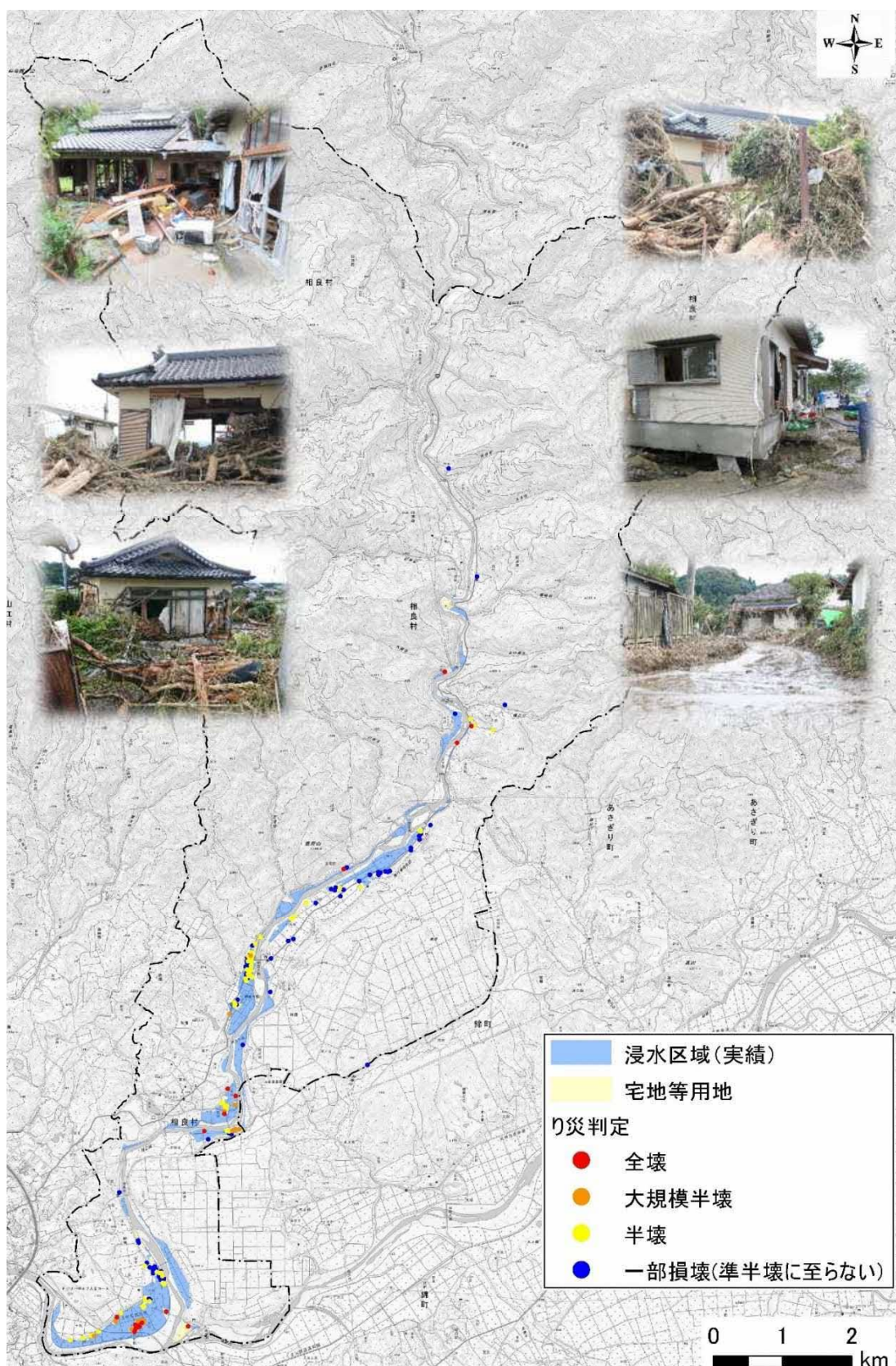
〔図〕建物被害状況及び浸水区域（実績）
