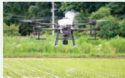
ジャンボタニシ防除剤を散布するドローン
