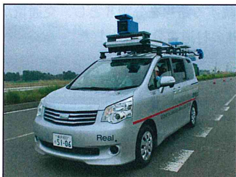
路面性状計測車例
